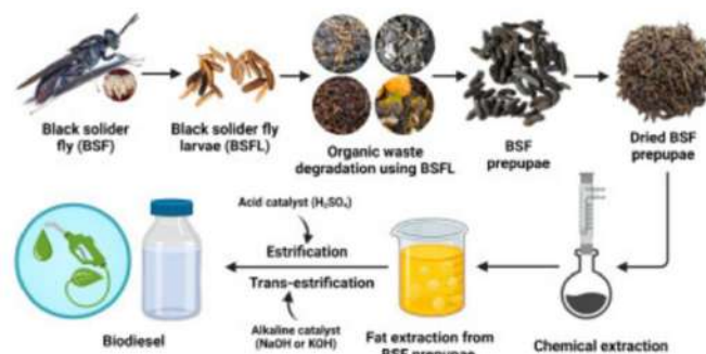
Gambar 4. Proses Biokonversi Sampah Organik menjadi Biodiesel (Mohan, et al , 2023)
